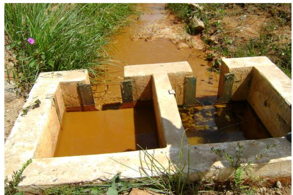
Figura 26 - níveis dos medidores V-7 (E) e V-6(D) após as injeções
