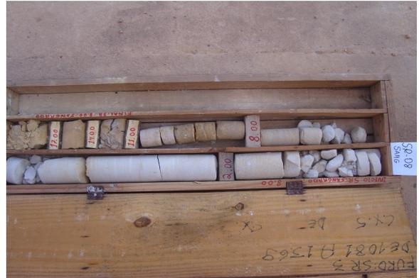
Figura 37 - testemunhos de sondagens do canal do sangradouro
